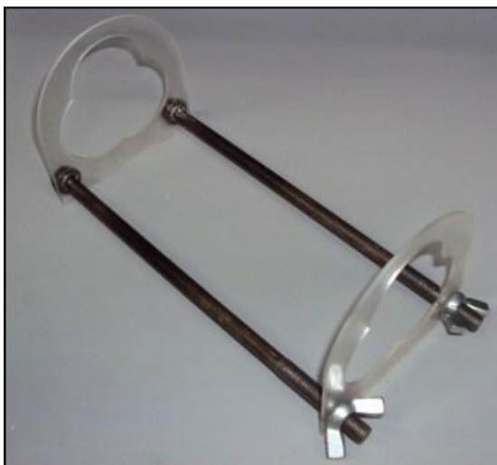
Fotografía 10. Dispositivo diseñado para la ubicación correcta de los palpadores.
