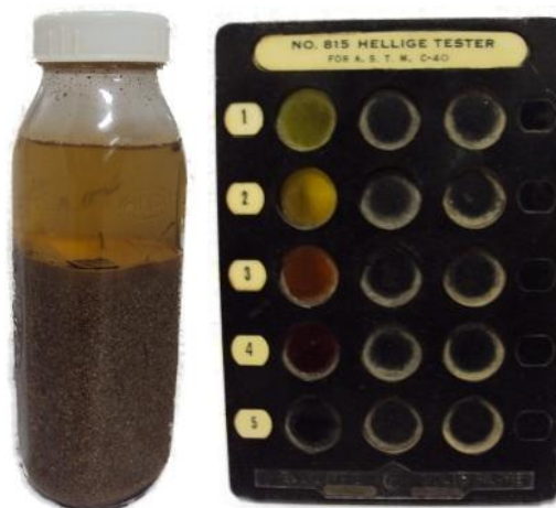
Fotografía 9. Resultado del ensayo de materia orgánica del agregado fino.
