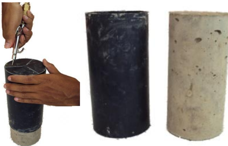
Fotografía 3. Desencofrado de los moldes plásticos a presión
