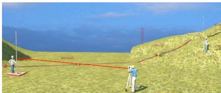
Figura 21. Contranivelación. Lectura del BN_{final} .
