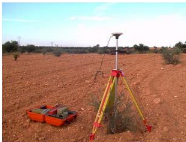
Figura 47. Estación Receptora Móvil.
