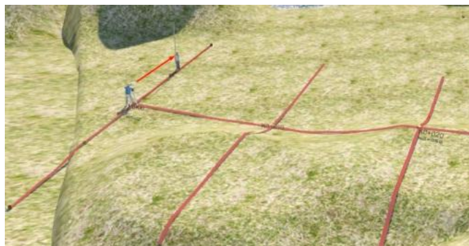
Figura 28. Lectura de la diferencia de nivel, K0+00,00.
