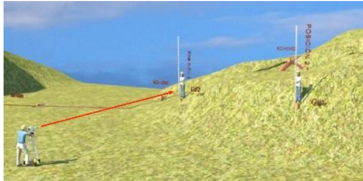
Figura 23. Contranivelación. Lectura del C#2, vista atrás.
