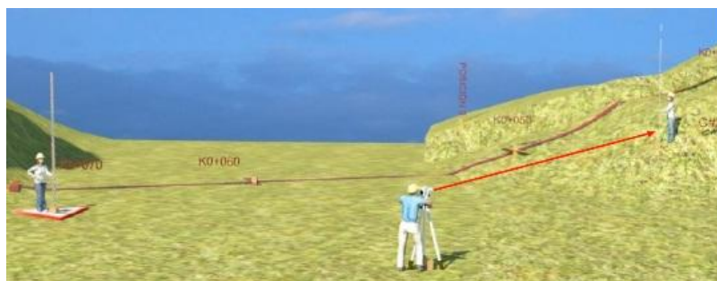
Figura 22. Contranivelación. Lectura del C\#2 , vista adelante.
