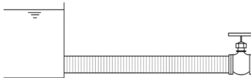
Figura 9. Inicio de la inversión del flujo en la tubería
