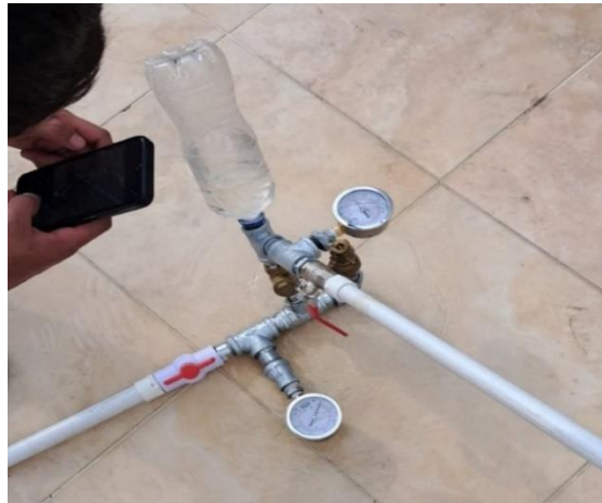
Figura 22. Montaje cuerpo del ariete hidráulico
