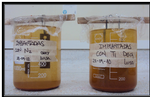
Fotografía 5. Montaje de las probetas sin e implantadas en solución NaCl al 3%
