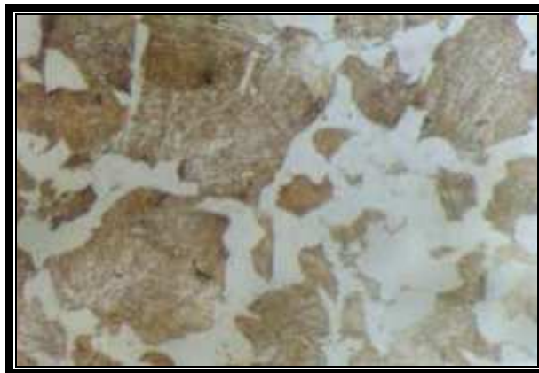
Fotografía 8. Microestructura del acero AISI SAE 1045; a 250x
