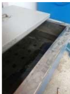
Figura 7. Probetas sumergidas en baño María a 60 grados Centígrados
