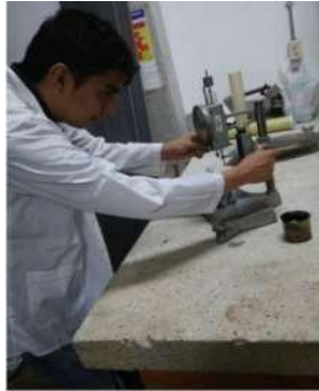
Figura 3. Ensayo de penetración estándar
