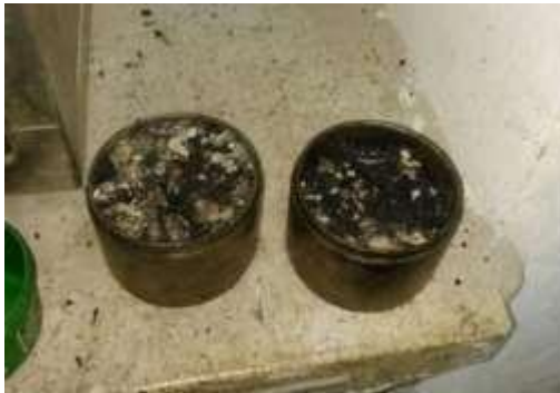
Figura 5. Probetas tipo Marshall sin desmoldar
