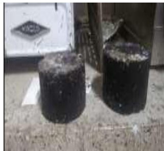
Figura 6. Probetas tipo Marshall desmoldadas
