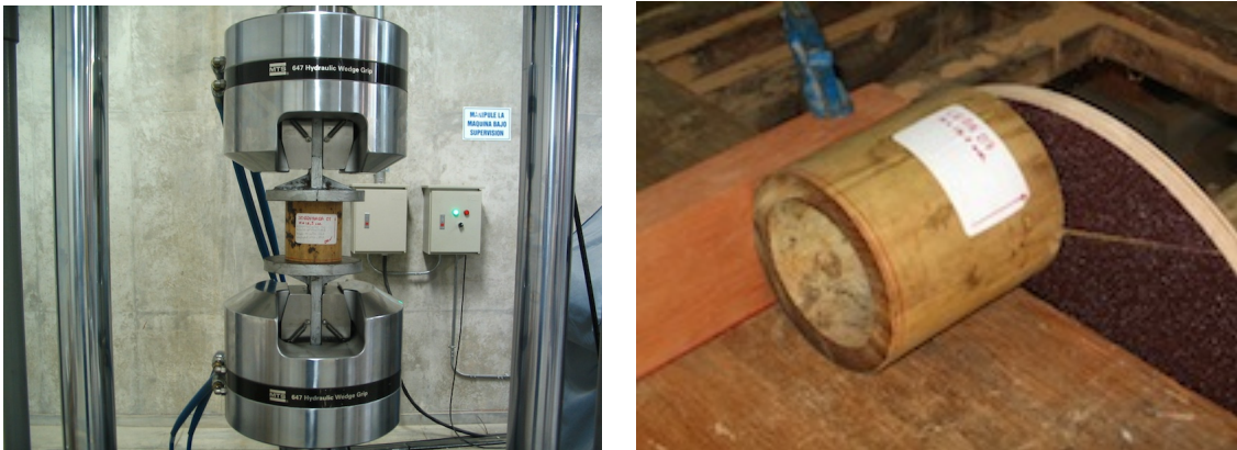
Figura 22. Izquierda: Probeta de compresión longitudinal acoplada al equipo de ensayos. Derecha: ajuste de cara transversal mediante disco abrasivo. Fuente:
