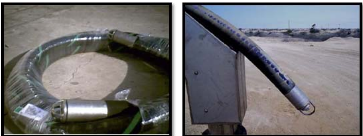
Figura 57. Manguera con Válvula de Retención.
