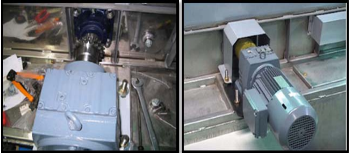
Figura 45. Motor Marca SEW Con Freno de Seguridad.
