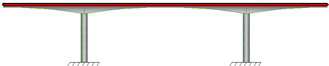
Figura 24. Deformación estructura completa.
