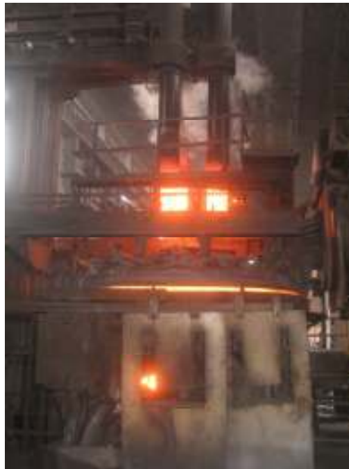
Figura 4 Fusión de la chatarra en horno de arco eléctrico para la producción de acero.
