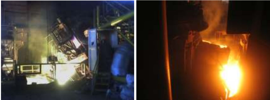
Figura 5. Cargue del acero en la cuchara.
