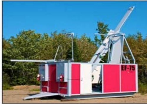
Figura 2. Equipo de perforación no convencional Slim Hole EF-75
