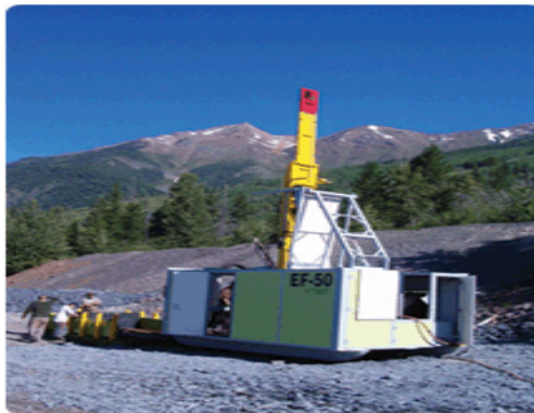
Figura 1. Equipo de perforación no convencional Slim Hole EF-50.
