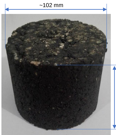
Fotografía 2.1. Dimensiones de las Briquetas según diseño Marshall.
