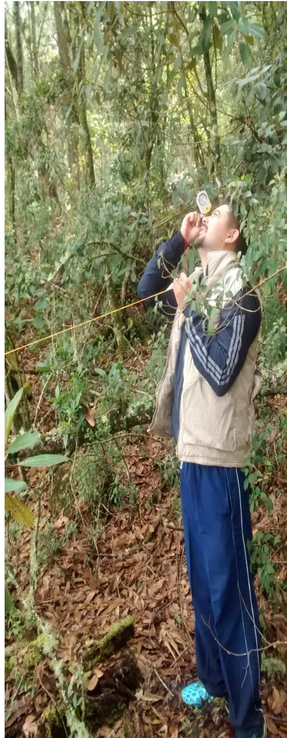
Medición de ángulos para el cálculo de alturas.
