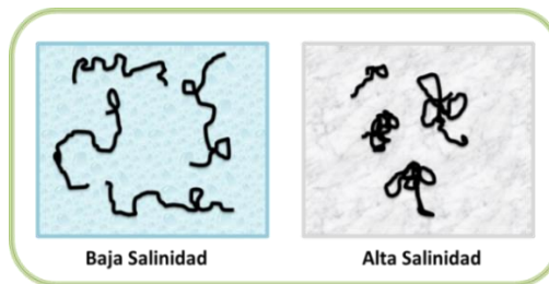
Figura 8. Efecto de una solución altamente ionizada sobre la poliacrilamida hidrolizada
