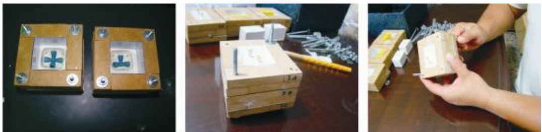
Figura 248. Segundo Llenado para Obtener la Otra Mitad del Molde
