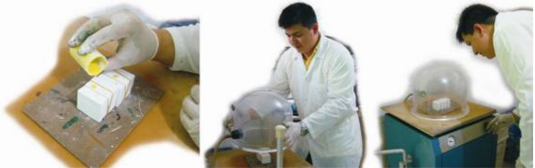
Figura 252. Procedimiento para Realización de Piezas en Resina
