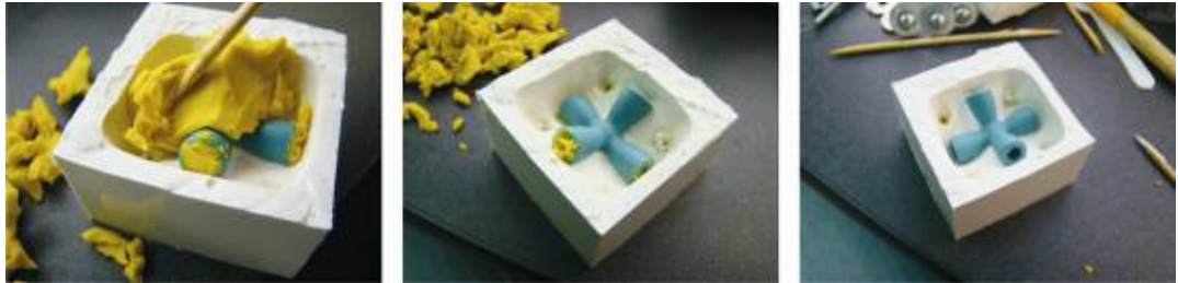
Figura 247. Remoción de Residuos del Prototipo
