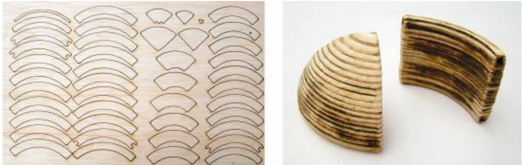
Figura 255. Cortes en Láser y Pegues de Superficies Esféricas
