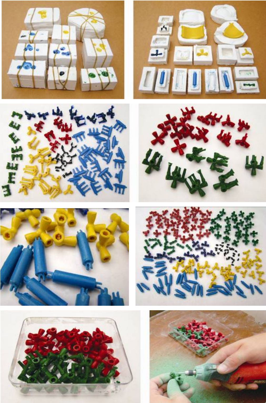
Figura 253. Obtención y Maquinado de Diversas Piezas en Resina
