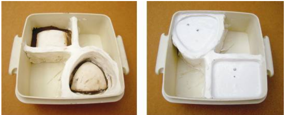
Figura 256. Elaboración de Moldes en Caucho de Silicona
