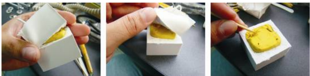
Figura 246. Proceso de Desmolde
