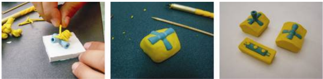
Figura 244. Preparación del Prototipo para Obtención de Molde
