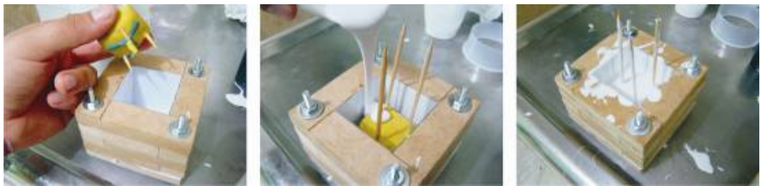
Figura 245. Vaciado de Caucho de Silicona sobre el Prototipo
