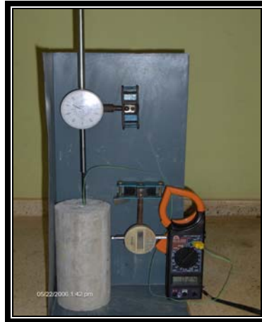
FOTO 30. Medida inicial de temperatura y deformación.
