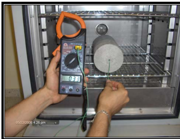
FOTO 31. Calentamiento de la probeta al horno
