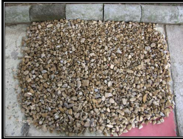
FOTO 5. Agregado \frac{3}{4} " trituradora el Cristal
