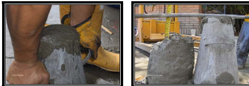
FOTO 13. Medida del asentamiento.
