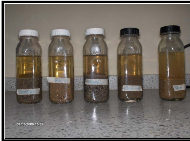
FOTO 10. Ensayo de materia orgánica en las muestras de arena.
