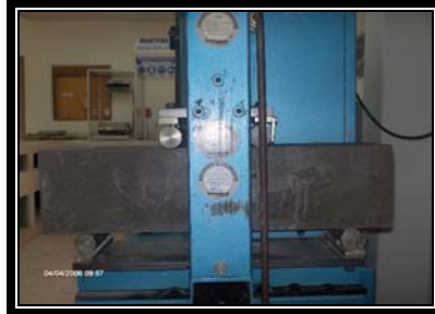
FOTO 14. Ensayo a flexión.
