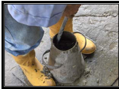
FOTO 12. Ensayo de asentamiento mediante el cono de Abrams.
