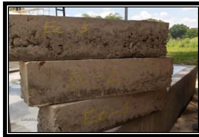
Foto 19. Apariencia vigas mezcla E3 Trituradora La Esmeralda.
