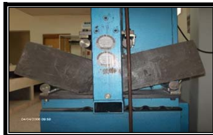
FOTO 15. Falla de la viga en el tercio medio.
