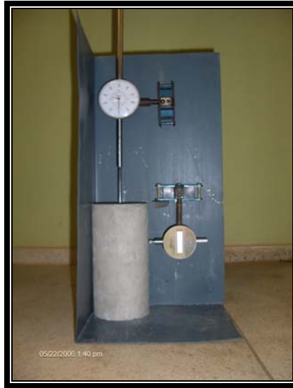
FOTO 32. Medida final de deformación en la probeta
