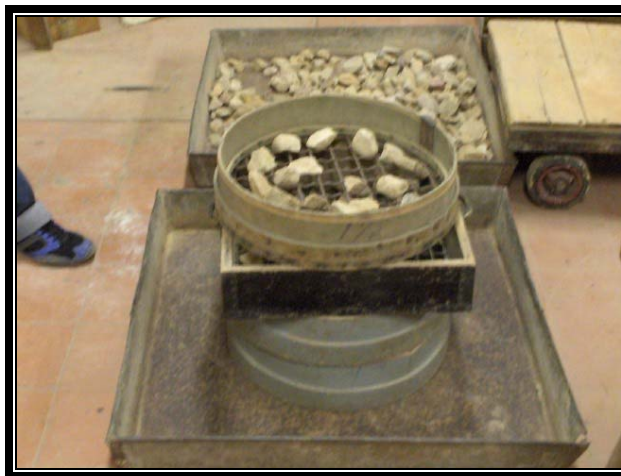
FOTO 8. Proceso de gradación agregado grueso
