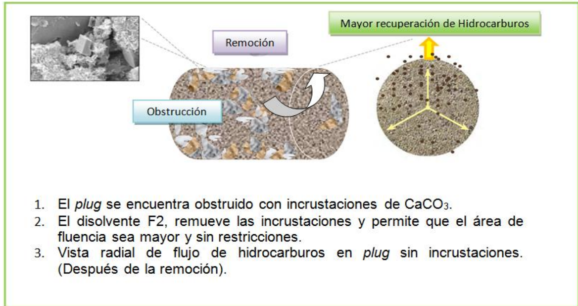
Figura 47. Remoción de \text{CaCO}_3 en plug , mediante Tratamiento Base EDTA.
