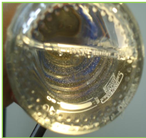
Figura 36. Micro cristales en Agua de Formación COL 69
