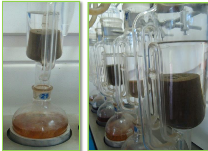
Figura 45. Método de Extracción Dean Stark-Soxhlet
