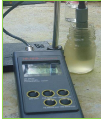
Figura 15. Medición de Conductividad en campo
