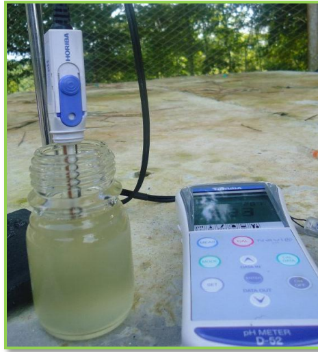
Figura 14. Medición de pH y T en campo
