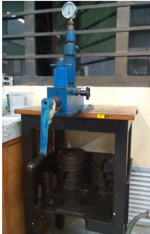
Figura 6. Máquina de calibración de transductores de presión
