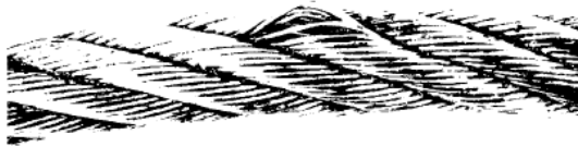
Cliché 11- Un sólo cordón es afectado por la extrusión de los hilos, aunque el examen de una mayor longitud del cable muestra que el defecto se repite regularmente sobre el mismo cordón a distancias de un paso.
