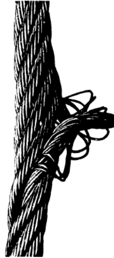
Cliché 10- Quebradura o extrusión del alma de acero generalmente como consecuencia de una deformación en cesta en una zona próxima. El cable debe ser retirado inmediatamente
