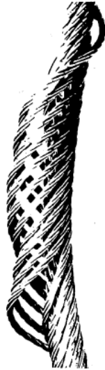
Cliché 9 - Deformación en cesta de un cable de varias capas de cordones. El cable debe ser retirado inmediatamente.
