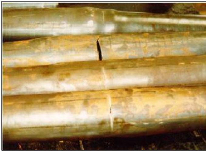
Figura 20. Fallo de la tubería por fatiga en Coiled Tubing.
