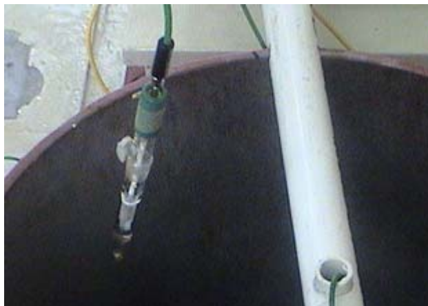
Fotografía 8 Medición del potencial de la estructura empleando el electrodo de referencia Ag/ AgCl
