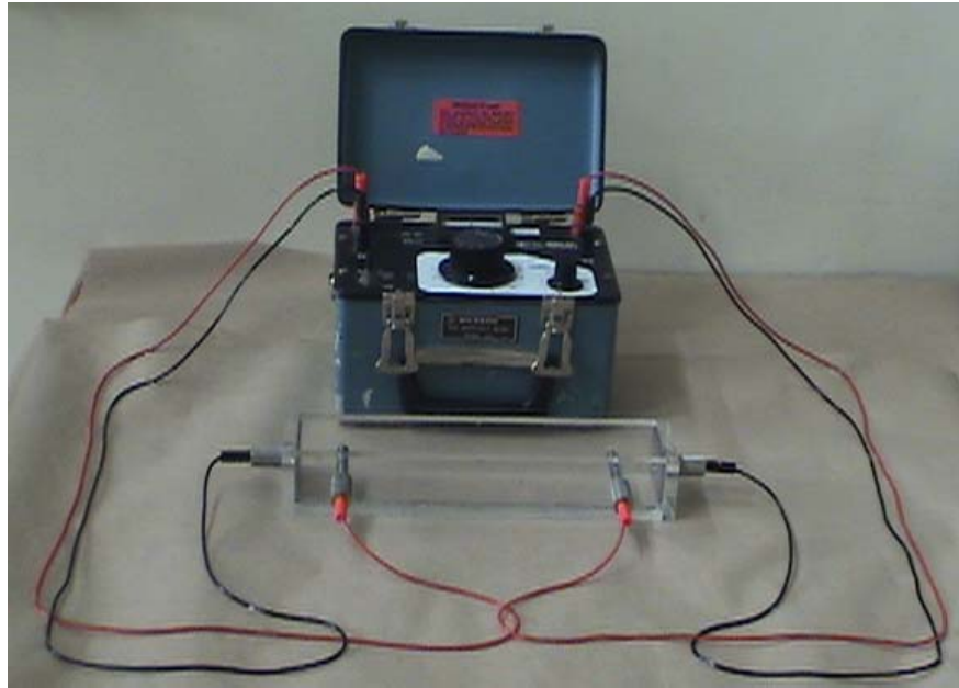
Fotografía 2. Disposición final para la medición de resistividades.
