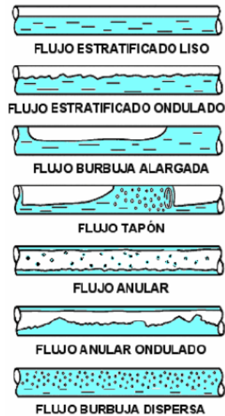
Figura 7. Patrones de flujo para tubería horizontal
