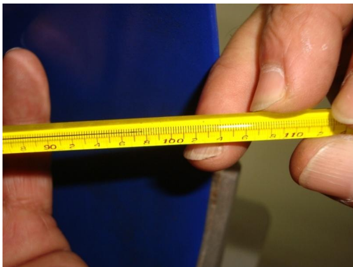
Figura 114. Termómetro de mercurio como instrumento comparador T=98.7^{\circ}\text{F}
