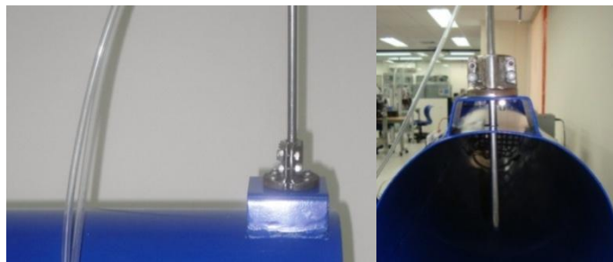
Figura 21. Montaje y soporte del tubo pitot
