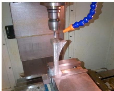
Figura 17. Fresado del soporte de la compuerta.
