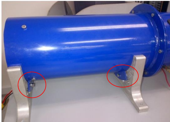
Figura 16. Montaje y acabado final de soportes
