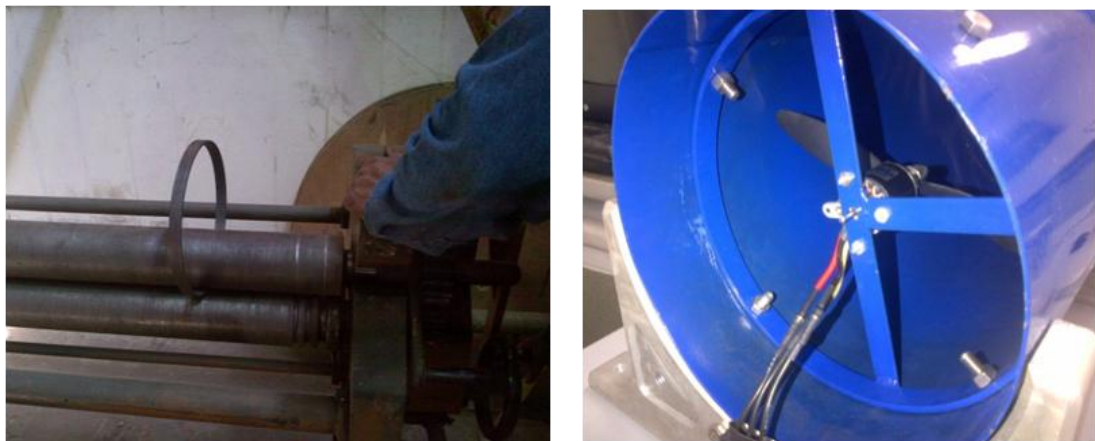
Figura 19. Proceso de construcción de soporte del motor
