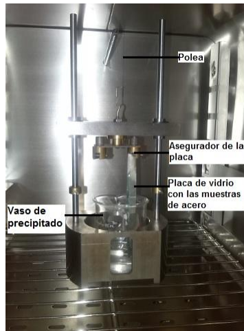
Figura 4. Equipo Dip coater TL0.01 MTI corporation empleado en el proceso de recubrimiento por inmersión
