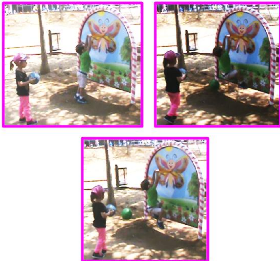
Imagen 142 Prueba de la resistencia del panel mariposa con el peso de un niño de 3 años.
