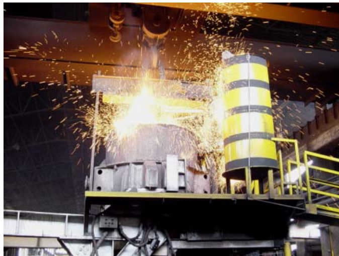
Figura 22. Toma de temperatura en cuchara para dar inicio a la colada.
