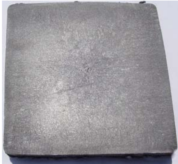
Figura 34. Macroataque a palanquilla 115*115 mm. para acero 1045.
