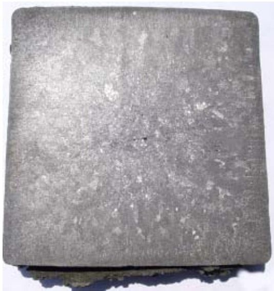
Figura 32. Macroataque a palanquilla de 115*115 mm. para acero A-36.
