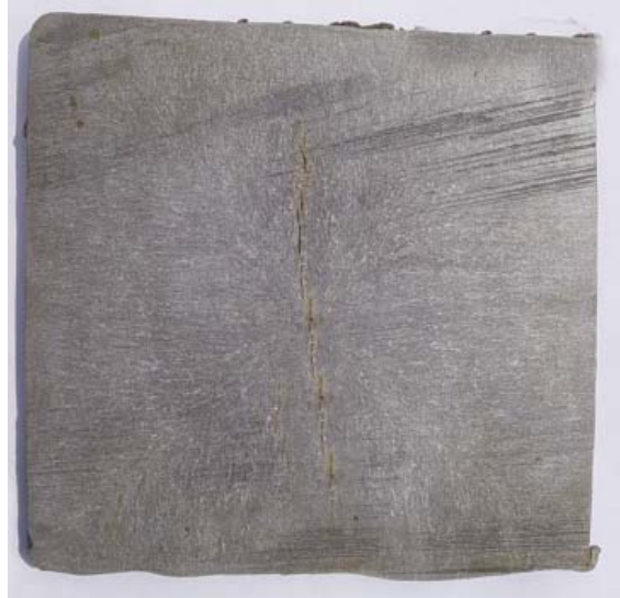
Figura 28. Grieta central en palanquilla 115*115 mm para acero A-572.
