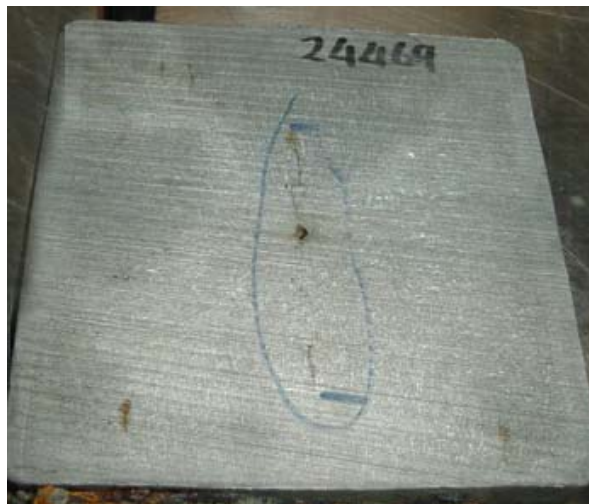
Figura 31. Rechufe y grietas en zona central en palanquilla de 130*130 mm para acero A-36.
