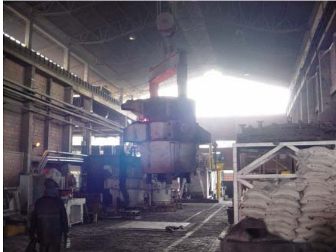
Figura 21. Transporte de la cuchara desde el foso de vaciado hacia máquina de colada continua.
