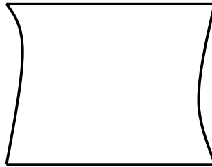
Figura 17. Concavidad, en palanquillas.
