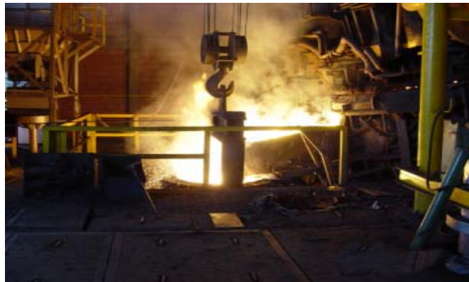
Figura 19. Inicio de vaciado de acero a la cuchara.
