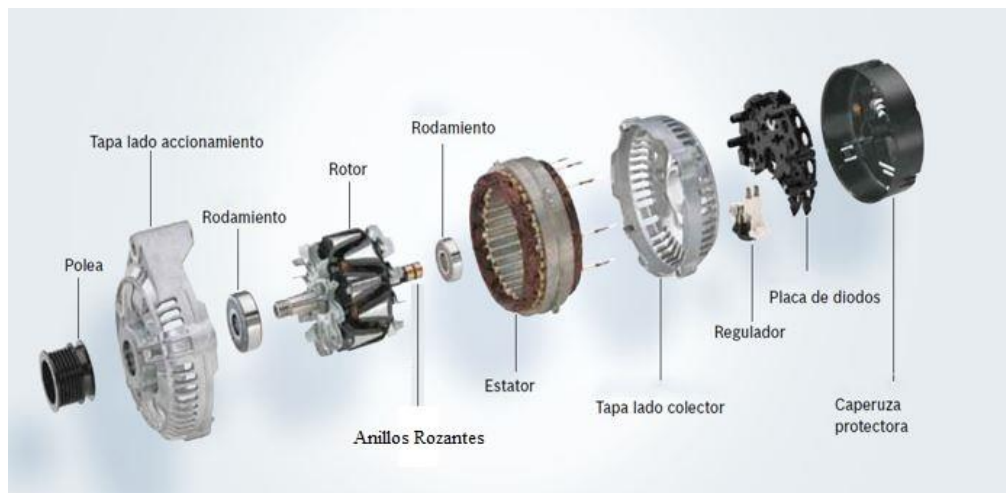
Figura 6. Partes del alternador
