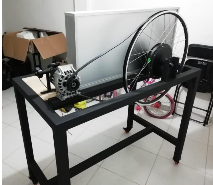
Figura 15. Máquinas motor brushless -alternador acopladas
