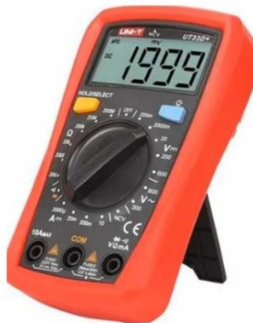
Figura 19. Multímetro digital UNIT UT33C.
