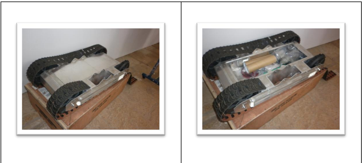
Ilustración 26. Plataforma móvil robótica. Imagen tomada durante la fase de armado.
