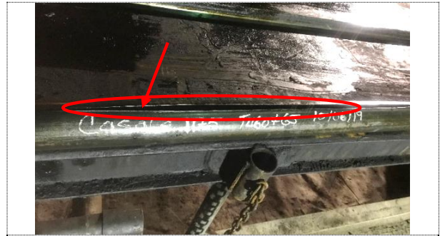
Figura 7. Corte longitudinal del tubular
