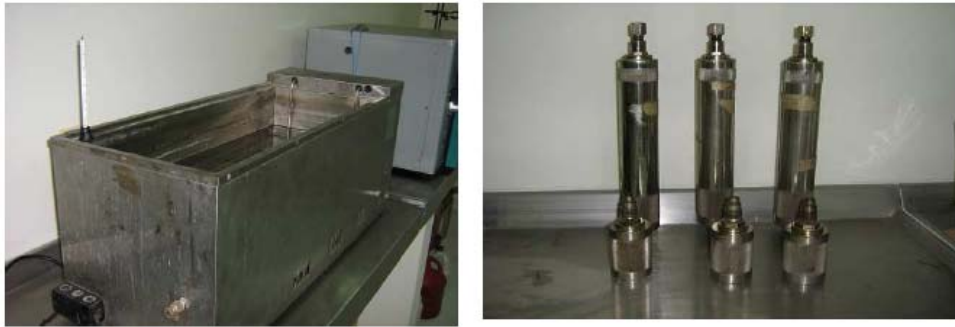
FIGURA 12. Baño térmico y cilindros para medir presión de vapor Reid
