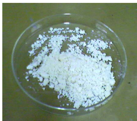
Figura 20. Acido Esteárico Obtenido en el Laboratorio.
