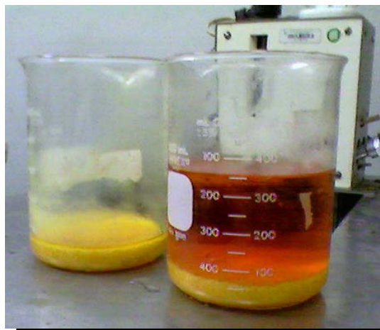
Figura 18. Cristalización con solvente.
