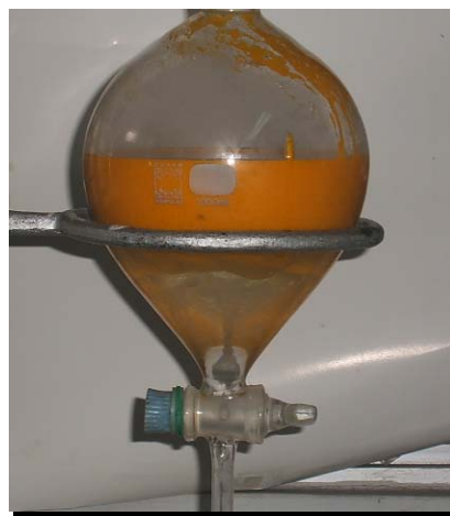
Figura 15. Separación de los ácidos grasos.
