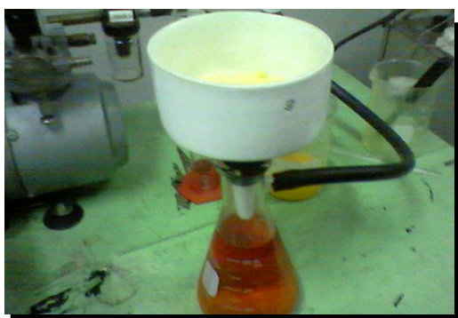
Figura 19. Filtración a vacío, ácido esteárico.
