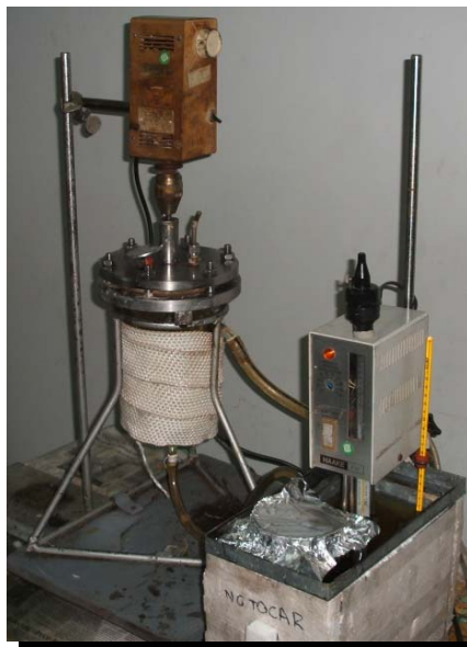
Figura 12. Montaje, Reacción de hidrólisis básica.
