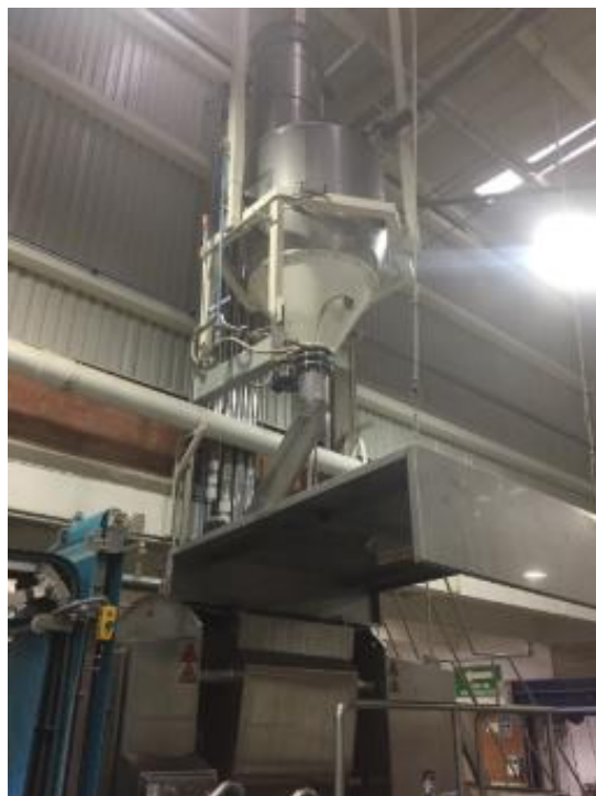
Figura 7. Mezcladora Peerless – Proceso de mezclado línea de tortillas THT.
