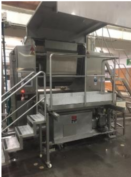
Figura 7. Mezcladora Peerless – Proceso de mezclado línea de tortillas THT.
