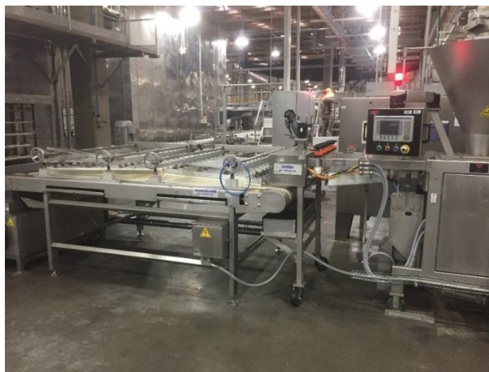
Figura 9. Equipo de dividido y mesa de modelado de masa línea de Tortillas de Trigo. Sentido producto de derecha a izquierda.
