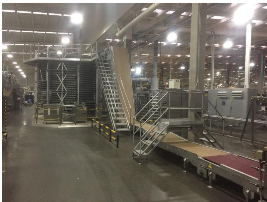
Figura 14. Banda de elevación y enfriador.
