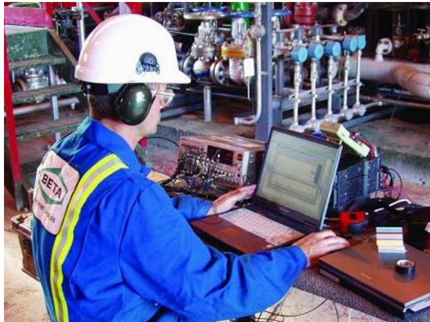
Figura 25. Ejemplo de labor de chequeo de vibraciones en un sistema.
