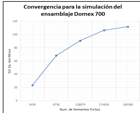
Figura 60. Gráfico de convergencia para el ensamblaje Domex 700
