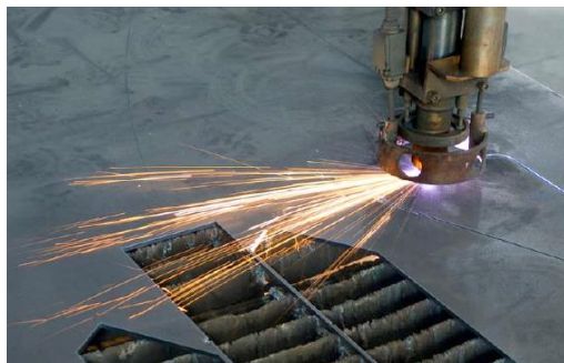
Figura 7. Proceso de corte térmico recomendado
