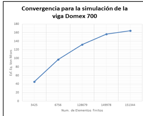
Figura 37. Gráfico de convergencia para la viga Domex 700
