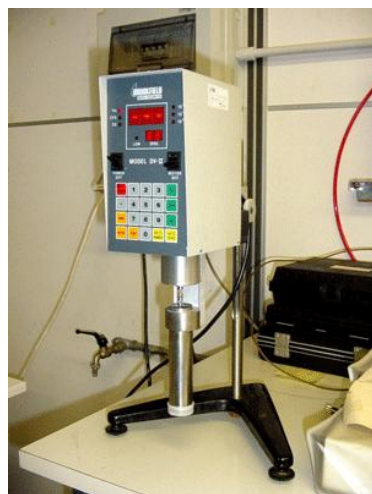
Figura 3. a) Viscosímetro brookfield, b) condiciones de medida
