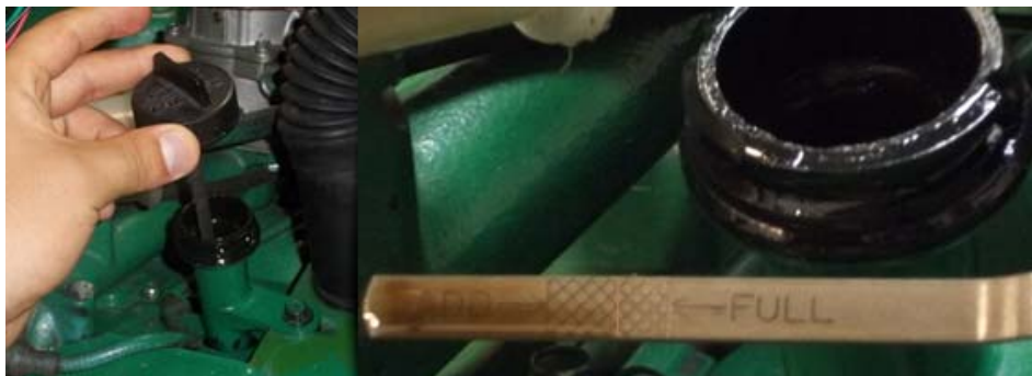
Figura 6. Verificación del Nivel de aceite.
