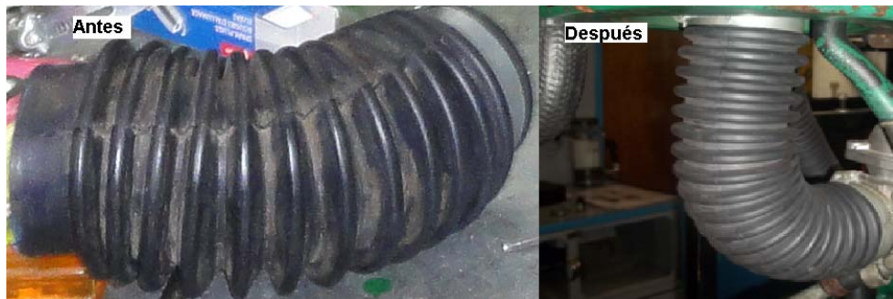
Figura 35. Manguera de paso de aire limpio (Antes y después).
