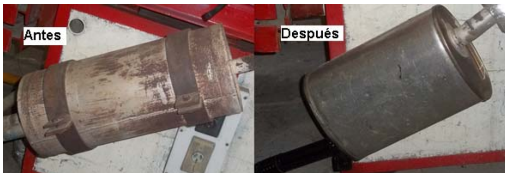
Figura 43. Silenciador del motor (Antes y después).
