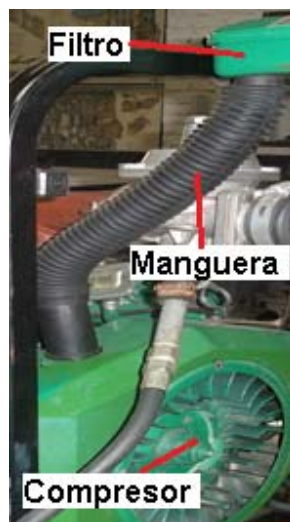
Figura 36. Manguera de paso de aire atmosférico a alta presión.
