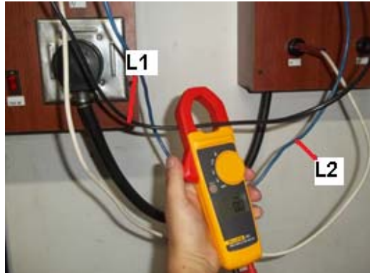
Figura 10. Medir corriente de las líneas L1 (cable negro) y L2 (cable azul).
