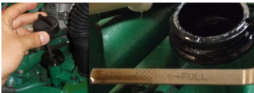
Figura 6. Verificación del Nivel de aceite.
