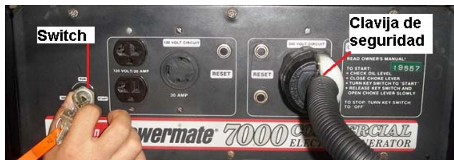
Figura 8. Switch del encendido del motor.
