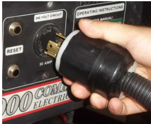
Figura 62. Verificar la conexión de la Clavija de seguridad del generador.
