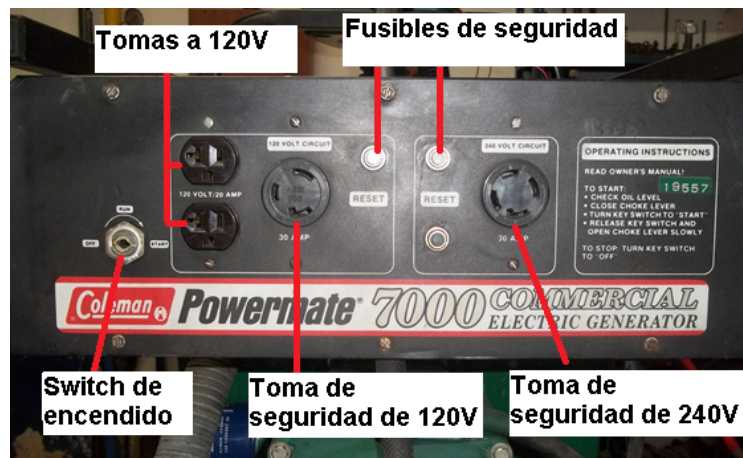
Figura 2. Tablero del generador.
