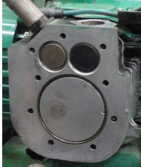
Figura 33. Limpieza de suciedad y sedimentos de la combustión.
