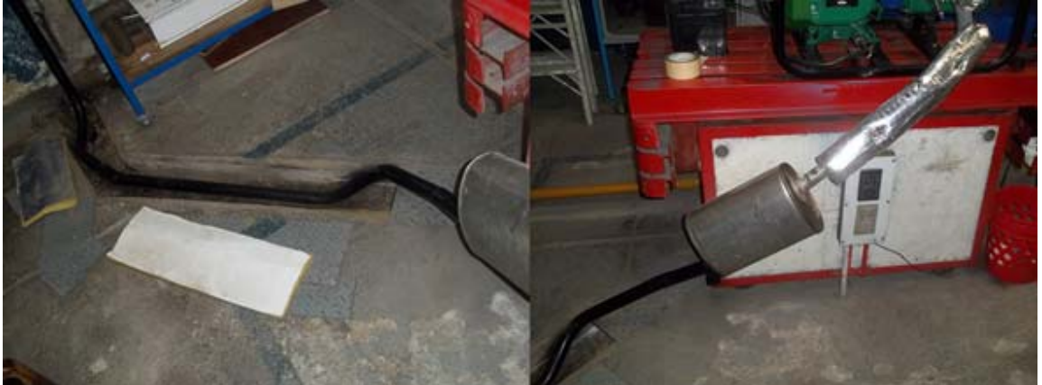
Figura 40. Tubería de escape nueva.
