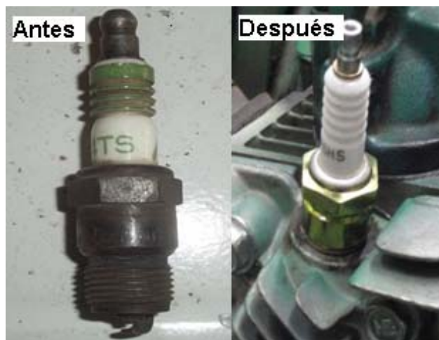
Figura 48. Bujías del motor (Antes y después).
