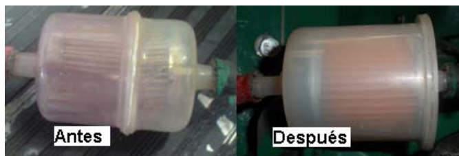
Figura 46. Filtro de la gasolina (antes y después).
