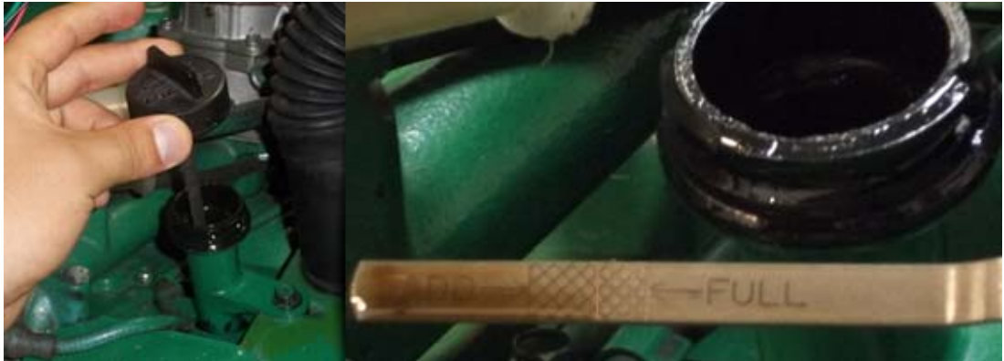
Figura 10. Verificación del Nivel de aceite.
