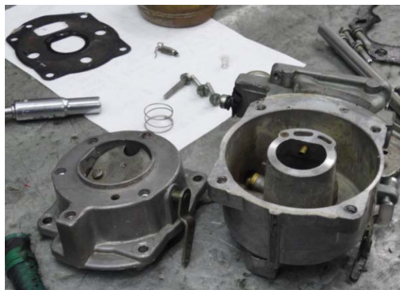
Figura 47. Mantenimiento del carburador.
