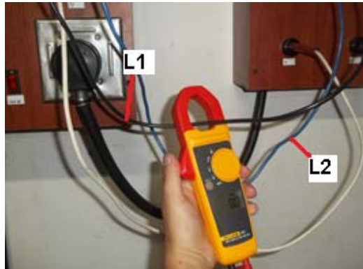
Figura 8. Medir corriente de las líneas L1 (cable negro) y L2 (cable azul).
