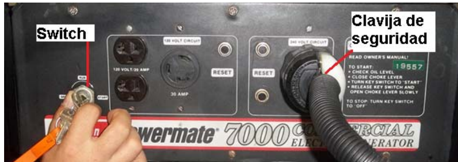
Figura 12. Switch del encendido del motor.
