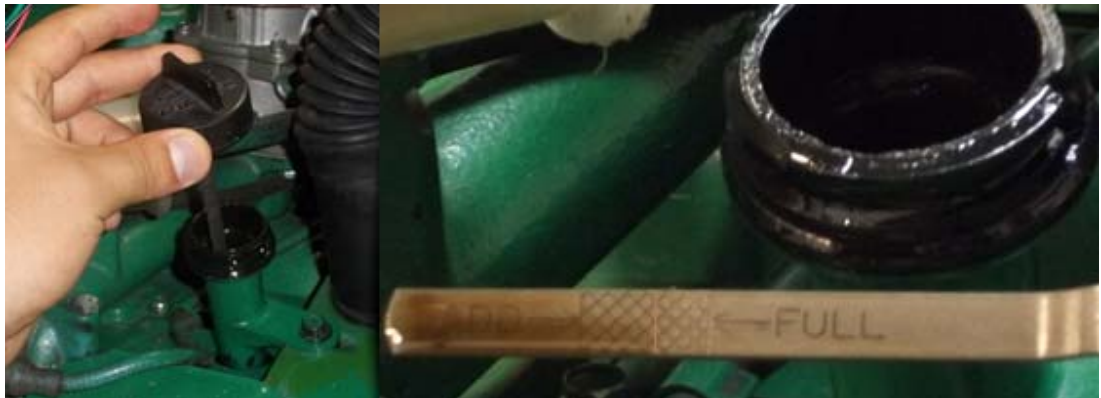
Figura 63. Verificación del Nivel de aceite.
