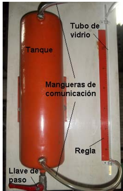
Figura 13. Tanque, tubo de vidrio, mangueras, regla y llave de paso.
