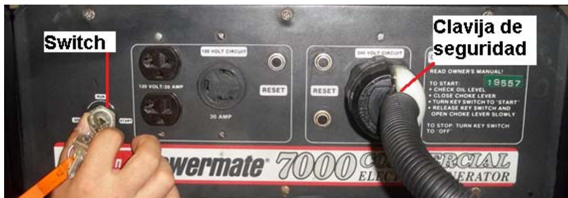
Figura 6. Switch del encendido del motor.
