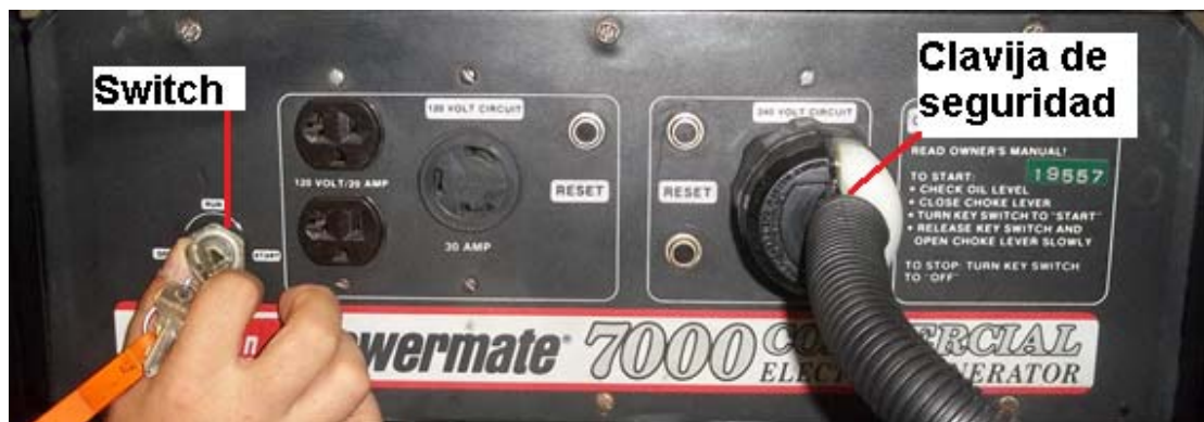
Figura 6. Switch del encendido del motor.
