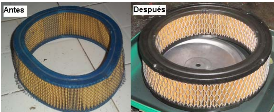
Figura 34. Filtro del aire (antes y después)
