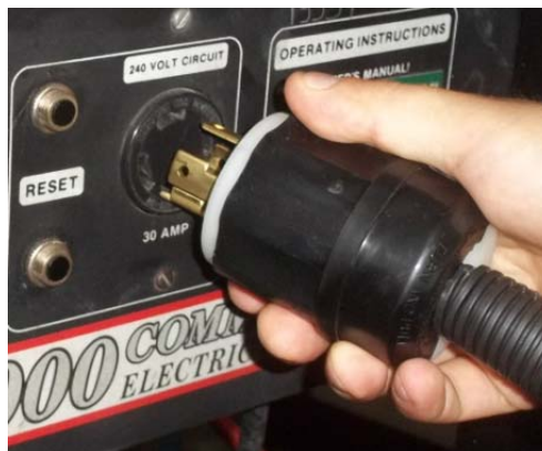
Figura 9. Verificar la conexión de la Clavija de seguridad del generador.
