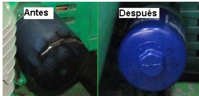
Figura 49. Filtro del aceite de lubricación del motor (Antes y después).
