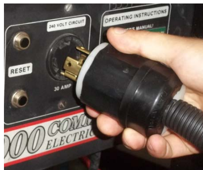
Figura 5. Verificar la conexión de la Clavija de seguridad del generador.
