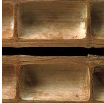
Figura 10, Sección corte longitudinal del tallo de bambú
