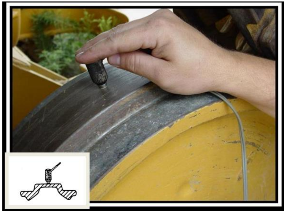
Figura 39. Medición de Rueda Guía
