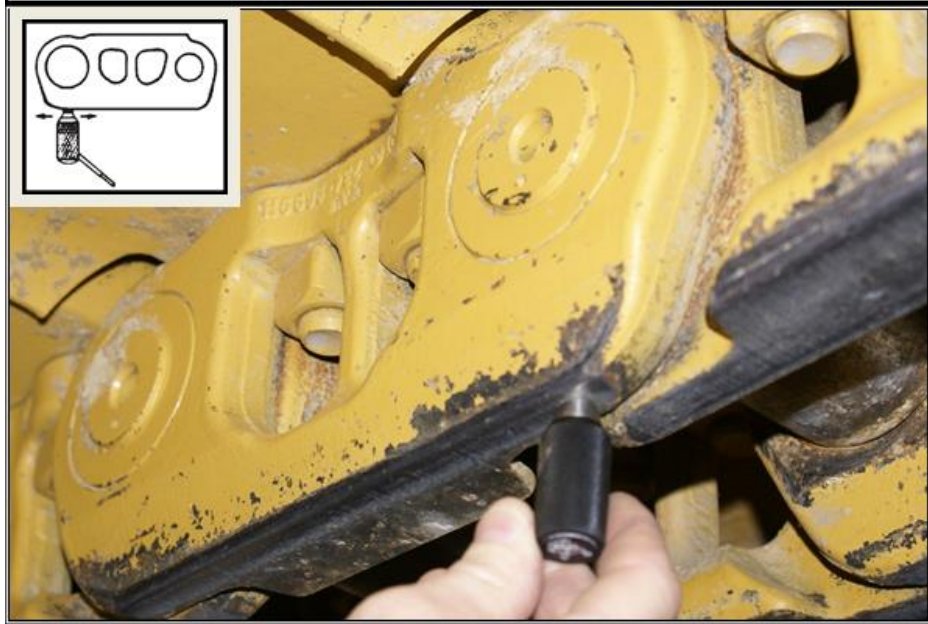
Figura 36. Medición de la cadena con Ultrasonido
