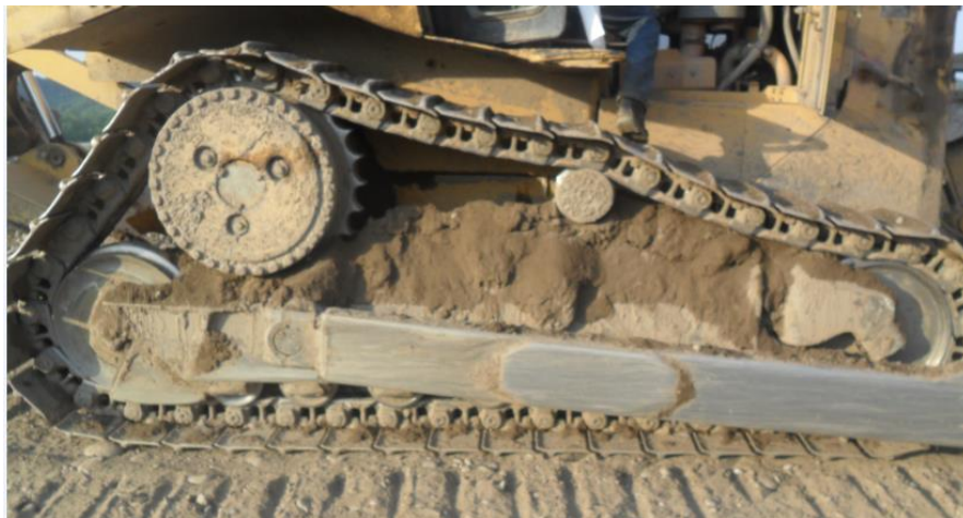
Figura 60. Tren de Rodaje sin Limpiar.
