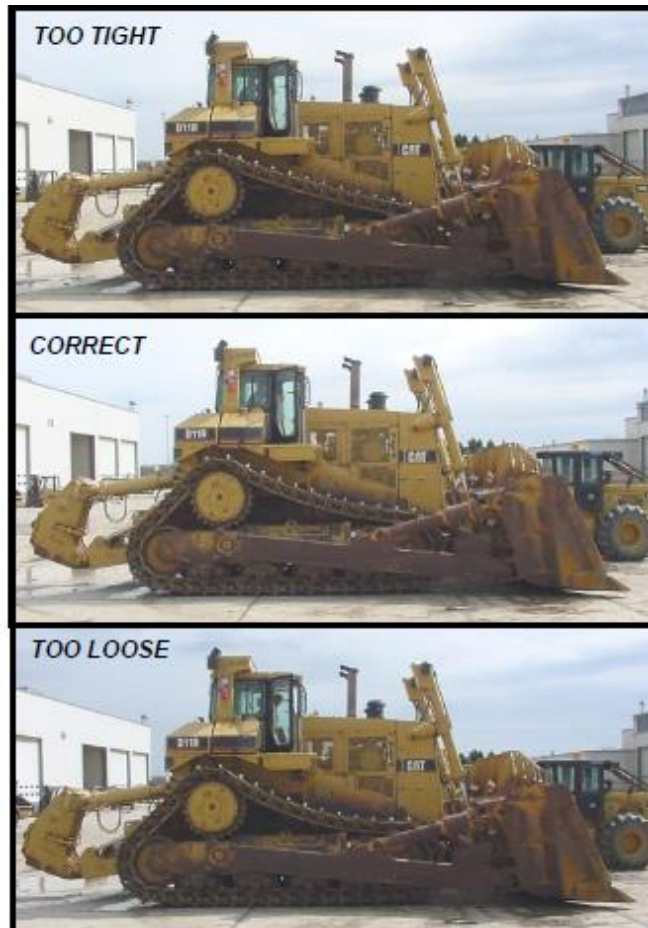
Figura 35. Correcta Tensión en la Cadena
