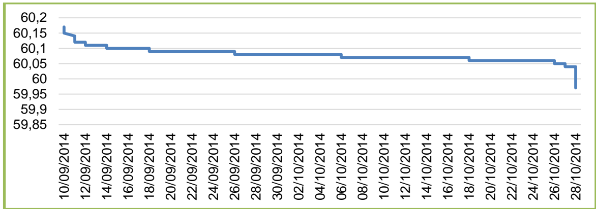
Figura 31. Comportamiento de la frecuencia en el edificio de ciencias humanas.
