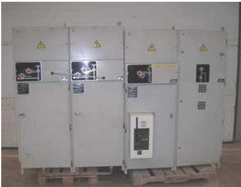
Figura 6. Seccionador tripolar celda compacta con seccionadores en el interior (Fuente www.electricidad-viatger.blogspot.com )
