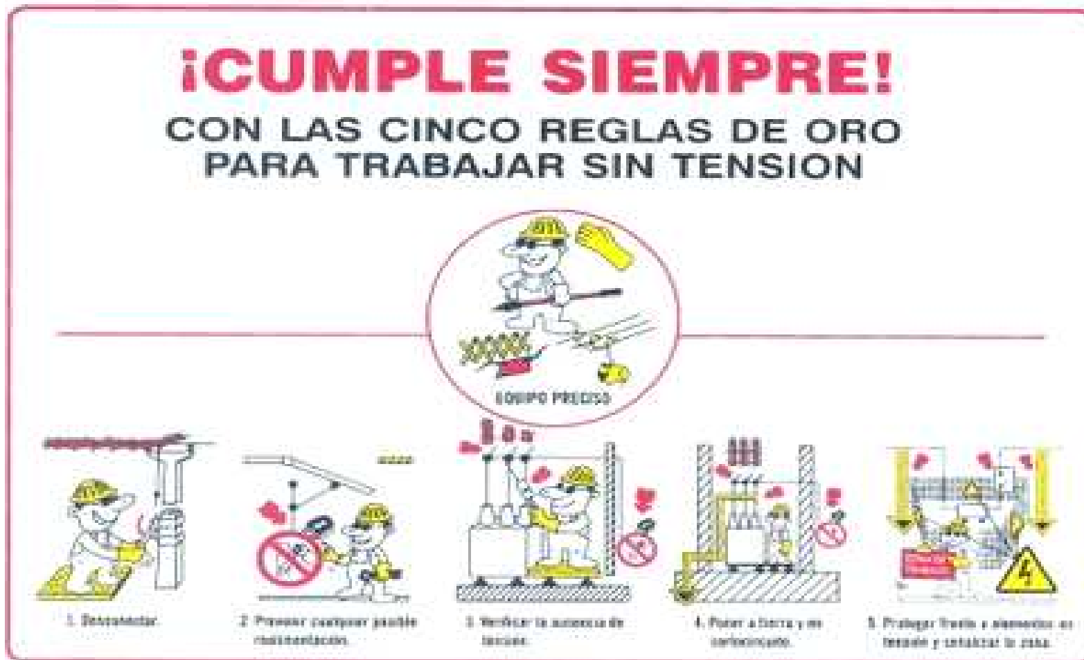
Figura 7. Cinco Reglas de oro tomada (Fuente www.electricidad-viatger.blogspot.com )
