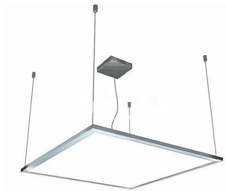
Ilustración 17. Luminaria Panel LED (60X60)cm 45W 6500K 3200 lm
