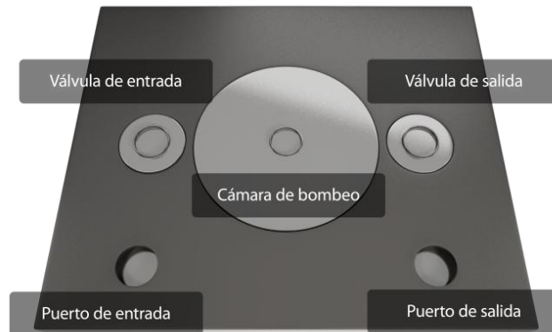
Figura 2. Microbomba para generación de vacío, micromaquinado
