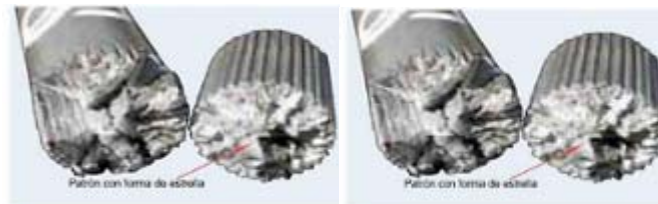
Figura 82. Causas de una falla por fatiga
