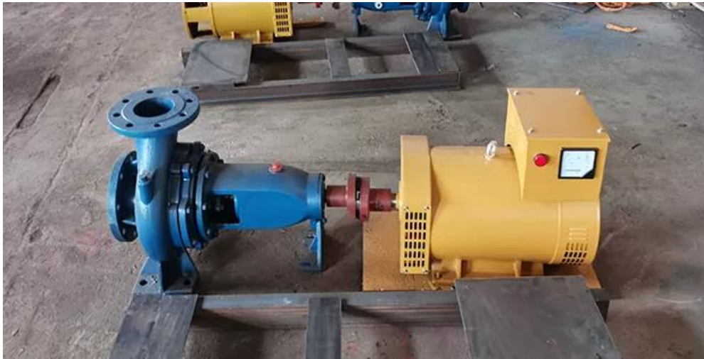
Figura 31. Turbina y generador.
