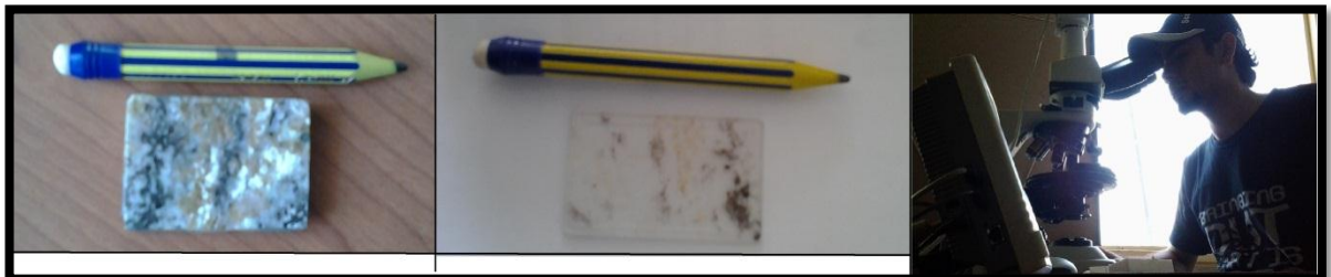
Fotografía 3. Testigo, Sección delgada (W32) y trabajo de laboratorio.
