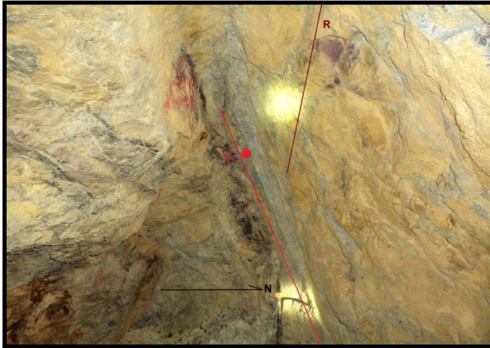
Fotografía 10. Zona de cizalla simple asociada a la cinemática de la Falla La Baja, fotografía de perfil del frente de la galería H1.
