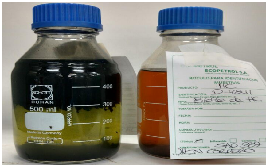
Figura 16. Fotografía que ilustra la parte de hidrocarburo del flujo de entrada de agua agria al D-4841.
