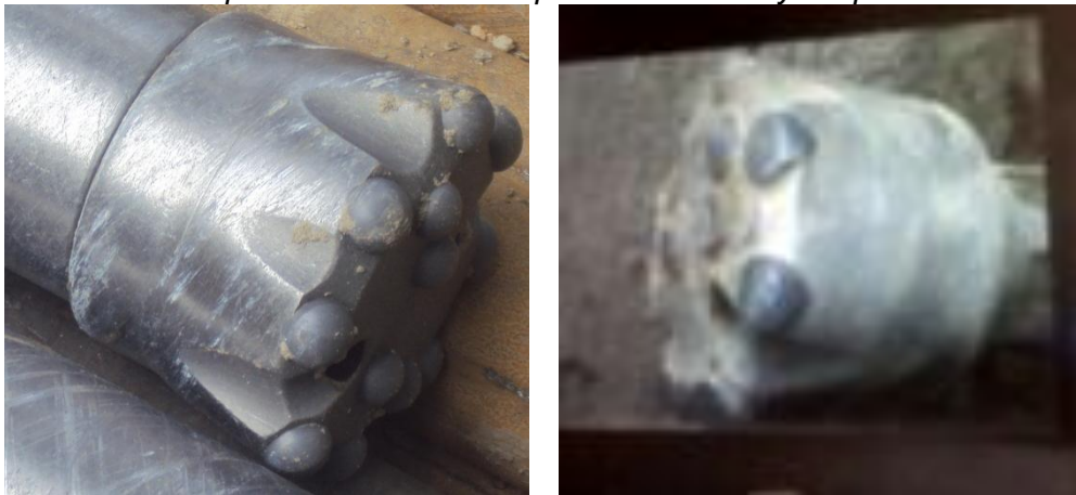
Ilustración 58 Comparación del martillos perforador antes y después de ser utilizado
