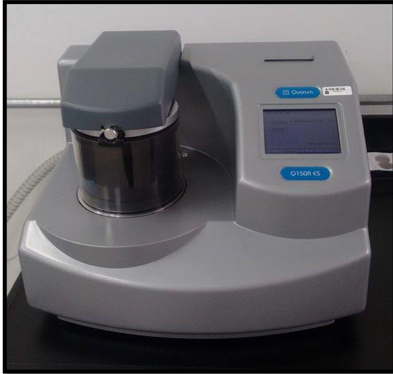
Figura 3. Máquina Evaporadora Quórum Q150R usada para el recubrimiento de las muestras
