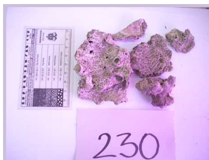
Figura 24. Muestra tomada al sur de la bahía, entre la desembocadura del Canal del Dique y Barú. En al foto se muestra solamente la fracción tamaño grava obtenida después del tamizaje húmedo, tiene fragmentos de coral y conchas.
