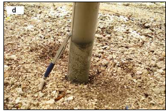
Figura 5. a. Equipo multimuestreador de lodos y sedimentos blandos. b. Equipo desmontado. c., d. muestras tomadas con el multimuestreador (estación 14 y 19 respectivamente).
