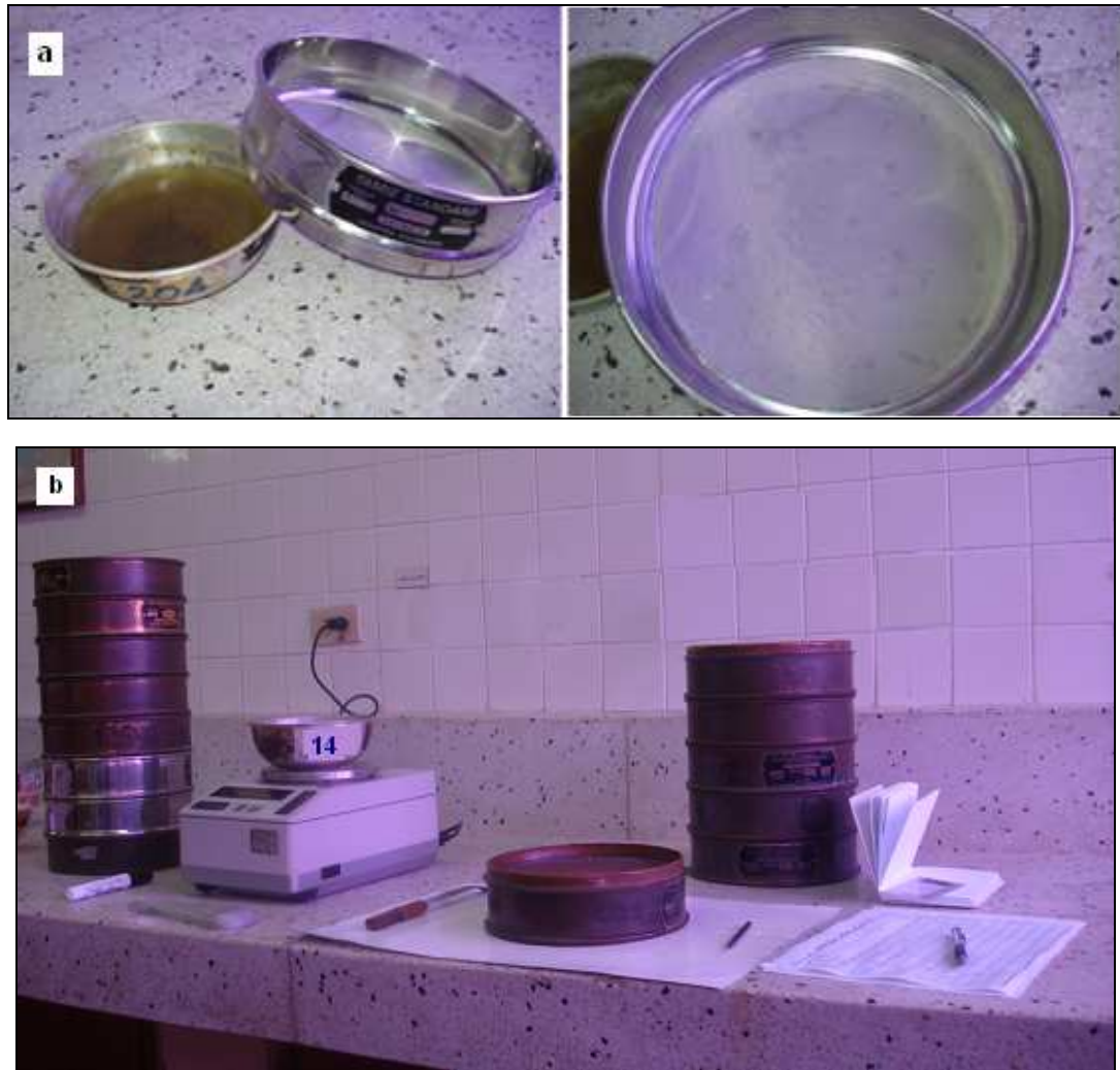
Figura 12. Material usado para realizar proceso de tamizaje. a. Tamiz con abertura de 0.063 mm usado para tamizaje húmedo. b. Juego de tamices con aperturas de: 4.75 mm, 3.35 mm, 2.00 mm, 1.18 mm, 600 micras, 500 micras, 425 micras, 300 micras, 250 micras, 150 micras, 125 micras, 106 micras, 63 micras y un fondo para retener partículas de tamaño inferior a 63 micras., balanza y formato de granulometría por tamizaje.
