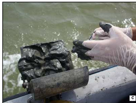
Figura 7. Draga tipo Van Veen usada para muestreo. a. , b. , lanzamiento y recuperación manual del equipo. c. , draga con muestra recolectada (estación 40).
