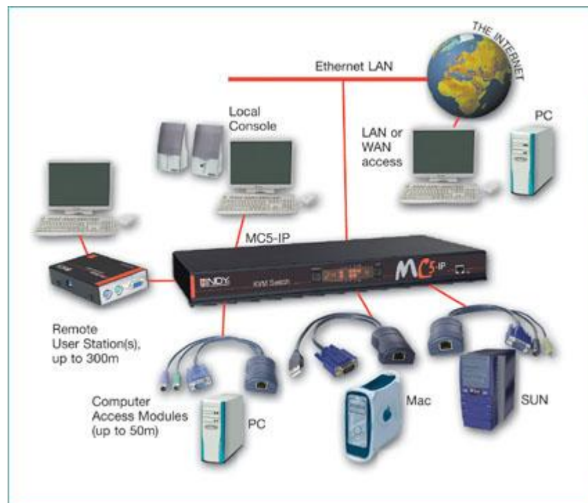
Figura 10: Esquema de funcionamiento del KVM sobre IP
