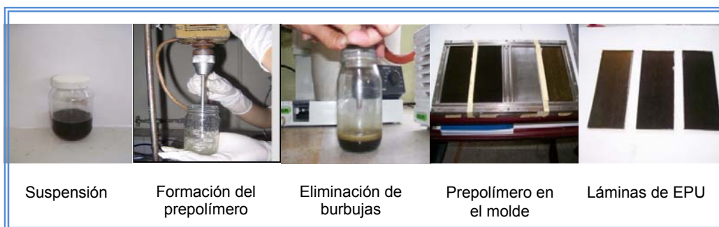
Figura 5. Elaboración láminas elastómeros de poliuretano.
