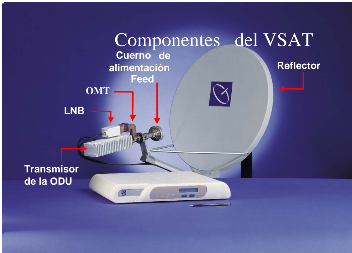
IMAGEN 6. Componentes del VSAT
